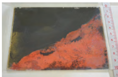
図8 乾板への塗料の塗布例（右はスキャンの後にボジ像に変換したもの）
