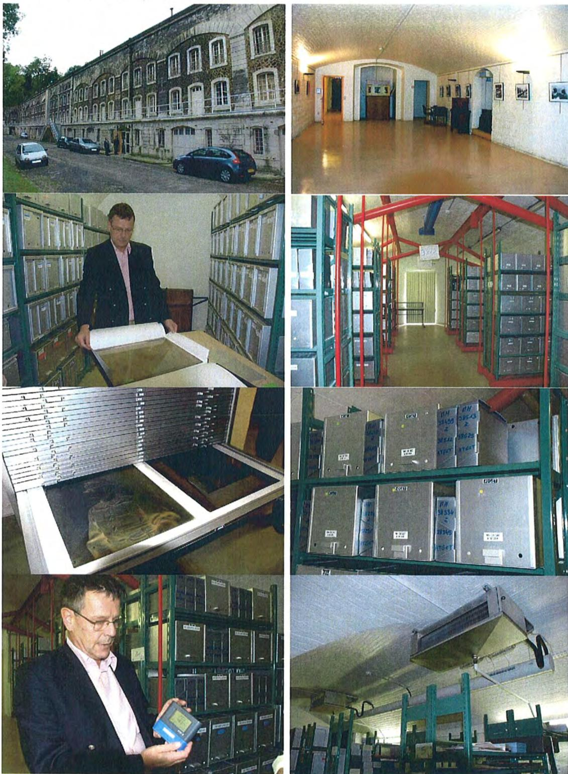
フランス文化省写真文化遺産保存局では千万点を超える写真原板を、この要塞のような施設で保存している。収蔵庫は 7,000 m<sup>2</sup>、40 室。収蔵棚の総延長は 1 km に及ぶ。1851 年以降に撮影した歴史的建造物の写真原板、ガラス板（湿板、乾板）60 万点、1850 年代以降のナダールスタジオの原板 16 万点（内湿板 2 万点）、これらは温度 17~20°C、湿度 40~50% で。フィルム数百万点は 17°C、45% で保存されている。
