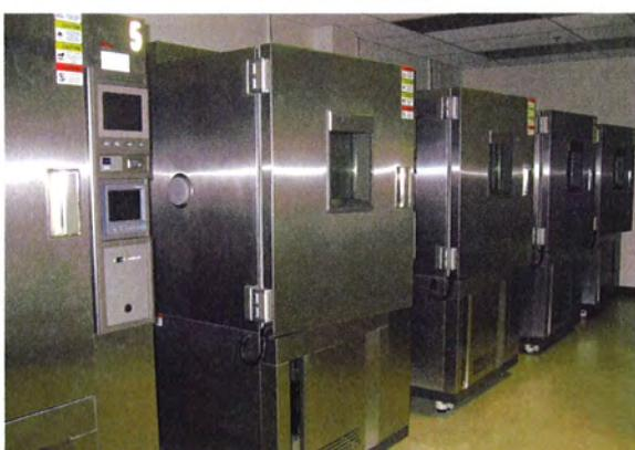
写真原板の強制劣化試験をする高温高湿装置
