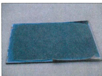
事例11: 銀鏡、画像膜の剥がれ
