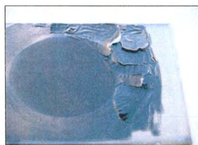
事例9: 墨によるマスクの剥がれ
